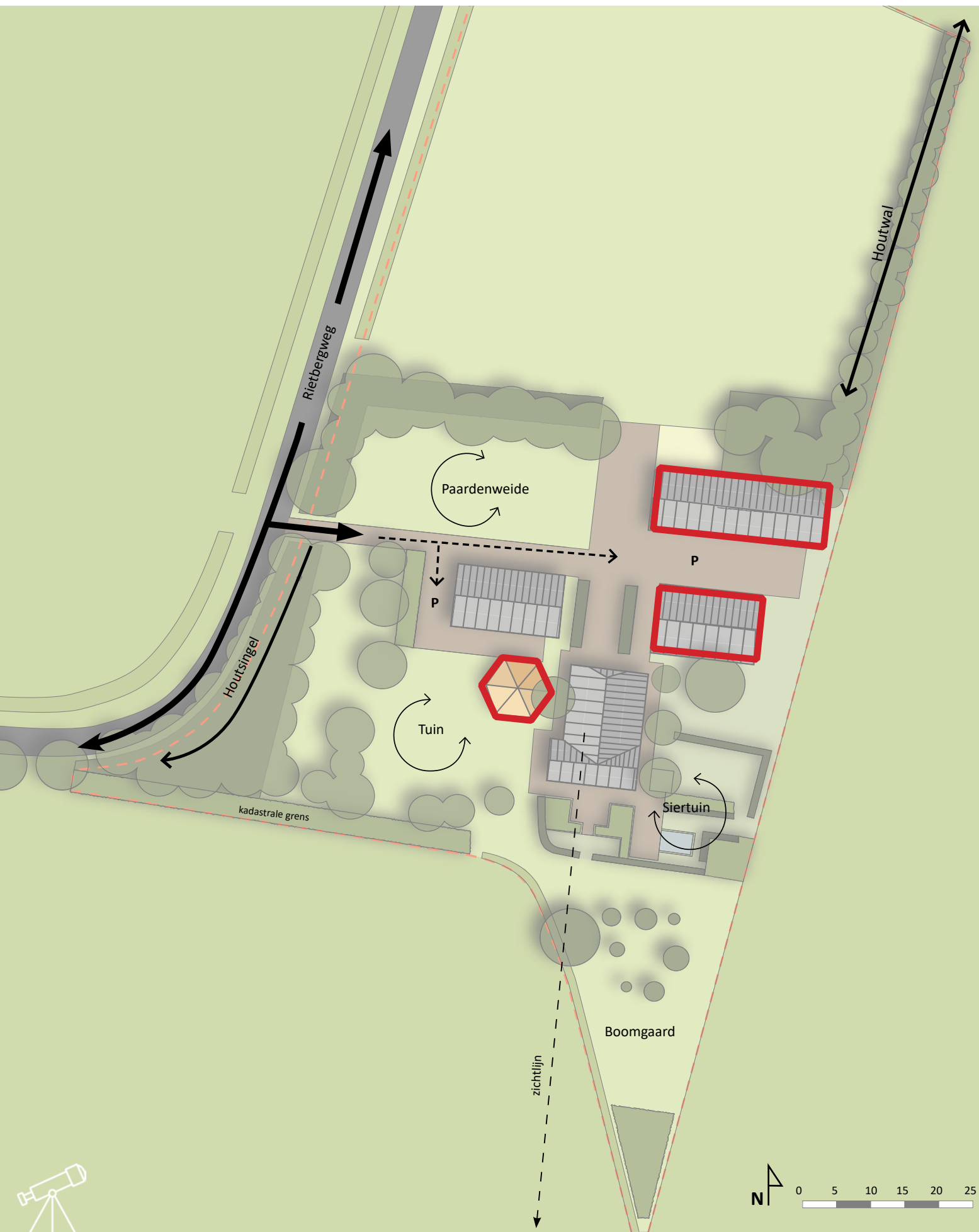
Huidige situatie ruimtelijke opbouw (rood omlijnd de te slopen bebouwing)
