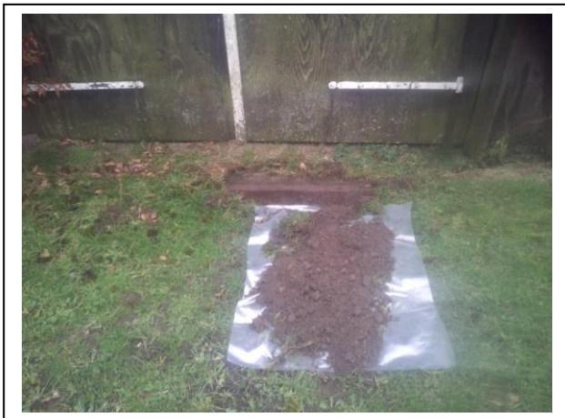
Foto 3. Opgegraven en gezeefd materiaal inspectiegat C03
