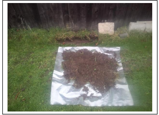
Foto 2. Opgegraven en gezeefd materiaal inspectiegat C02
