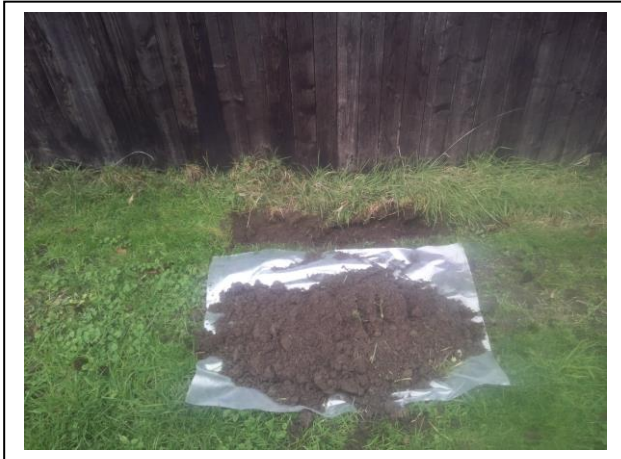
Foto 1. Opgegraven en gezeefd materiaal inspectiegat C01
