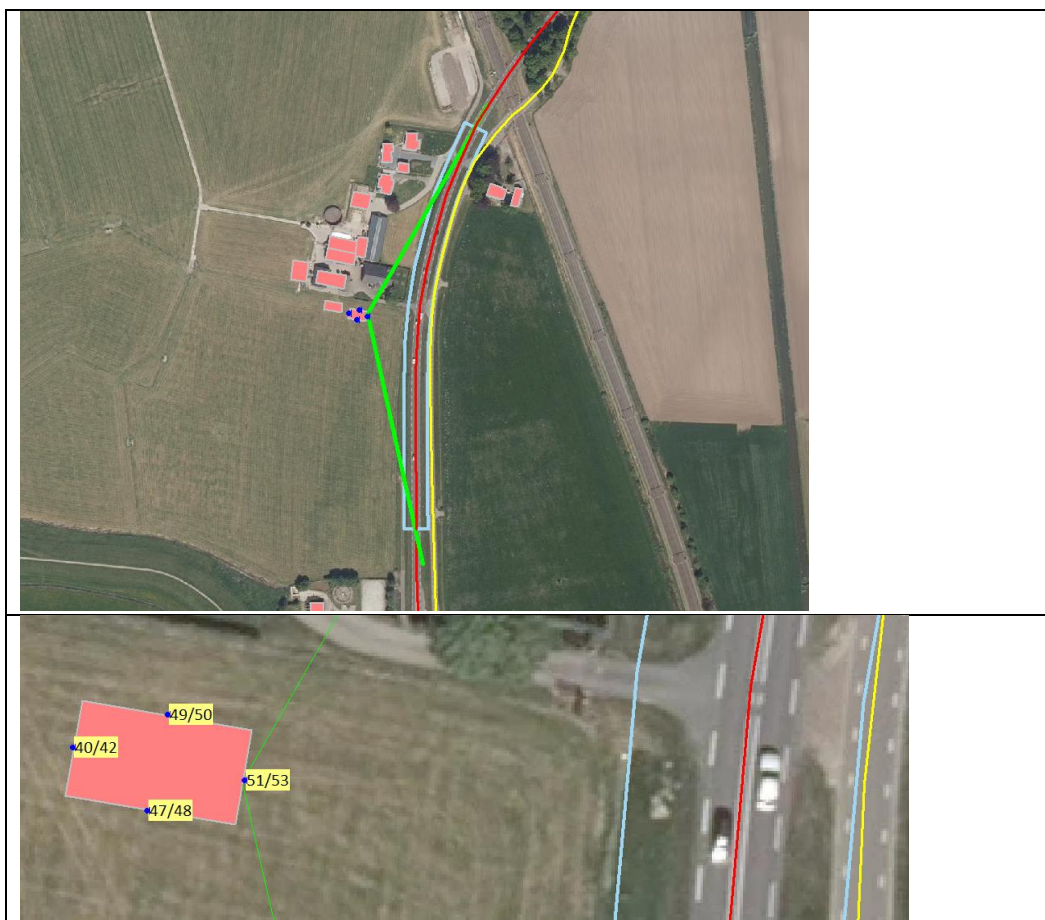
Figuur 7 Mogelijke bronmaatregel, geluidsreducerend wegdek (Dunne dekragen type B) over een lengte van 350 meter.
