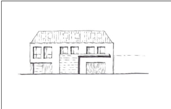
Figuur 6: laad- en loshof als geluidswerende maatregel ter plaatse van nieuwe losplek Albert Heijn
