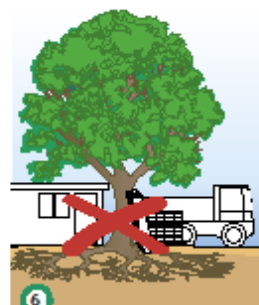
6 Plaats geen bouwmaterialen of bouwkelen en parkeer geen voertuigen onder de kruin van de boom. De grond raakt hierdoor verdicht waardoor boomwortels afsterven.
