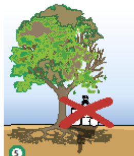
5 Voorkom dat schadelijke stoffen zoals cementwater, kalk, zout, olie of andere chemische stoffen bij de boom terecht komen.
