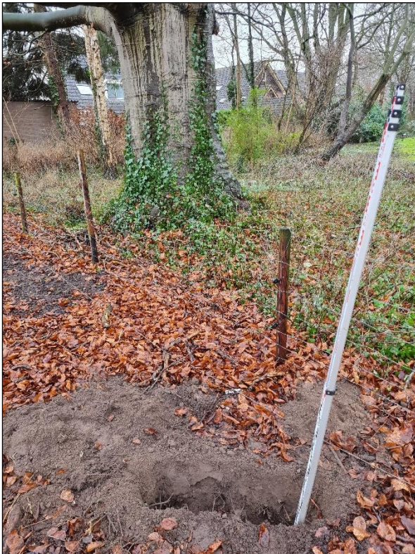
Afb. 5; de profielsleuf A is gegraven op vijf meter uit het hart van de stam.
