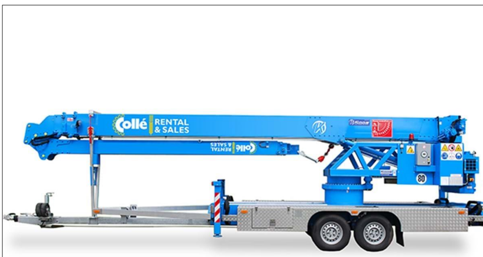
Voorbeeld van een lichte, mobiele kraan. Geschikt voor aanreiken dakpannen en plaatsen gordingen.
