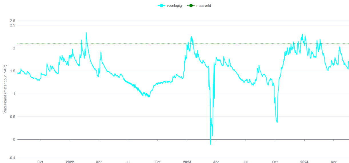
Afbeelding 2.5: Gemeten grondwaterstanden peilbuis WDOD (BRO-ID: GLD000000052951)
