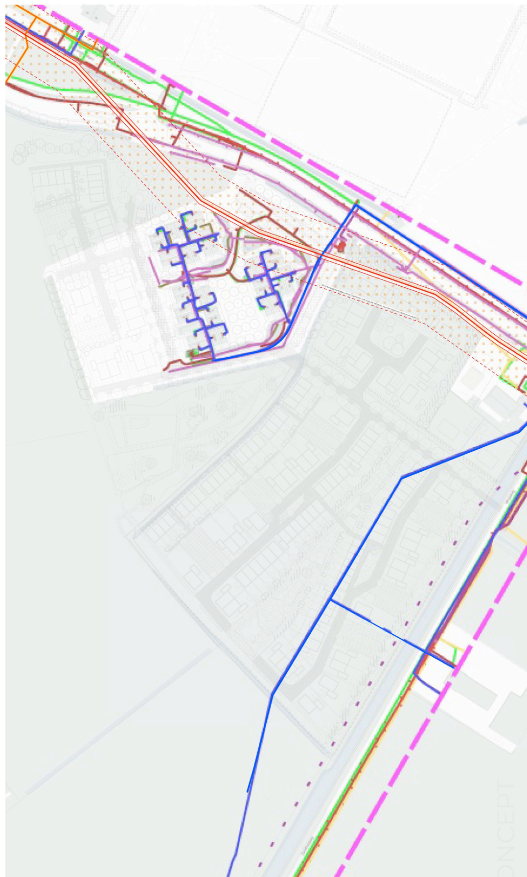
Inmeting 21 april 2023 met KLIC melding/ ondergrondse situatie
