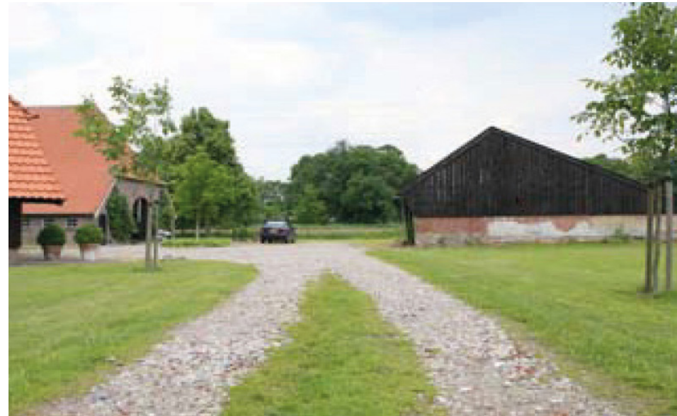
Afbeelding 42. Het karrenspoor leidt tot de noordkant van de schuurwoning. Dit kan uitgevoerd worden door twee halfverhardingsstroken met een grasbaan er tussen.
