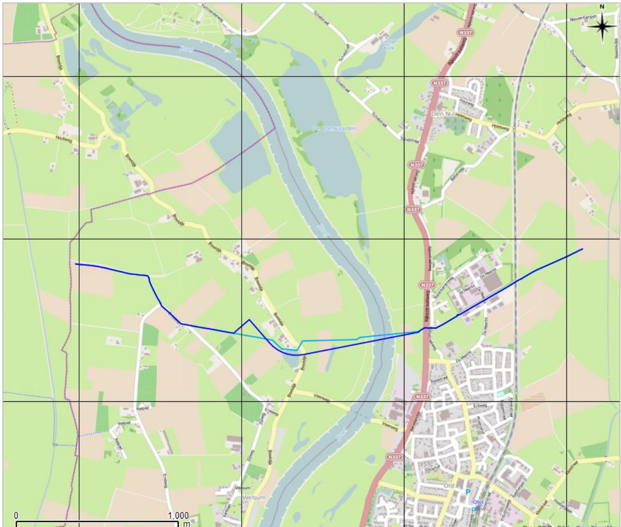
Figuur 1 Ligging van gastransportleiding N-556-60. De ligging van de leiding in de huidige situatie is weergegeven in het lichtblauw en de ligging in de toekomstige situatie in het donkerblauw. 1
