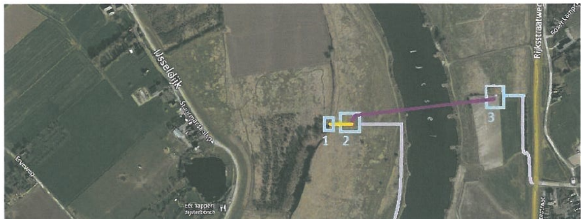
Figuur 1.3. Luchtfoto van het plangebied van fase 1. Lijnen: bestaande leiding wegtrekken (geel), bestaande HDD (paars), toegangswegen (lila). De drie werkputten met nummers zijn aangegeven met een blauwe rechthoek. (Bron Bing maps)
