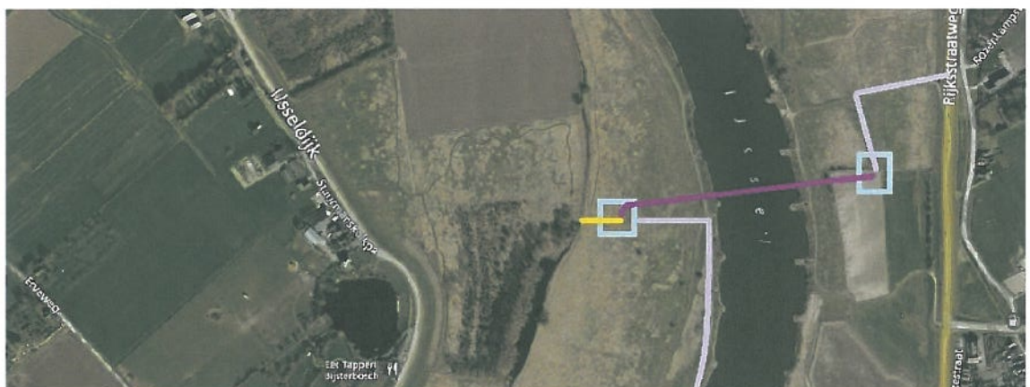
Figuur 3.11. Luchtfoto van het plangebied van fase 1. Lijnen: bestaande leiding open ontgraving (geel), bestaande HDD (paars), toegangsweg (lila). Een bouwput is aangegeven met een blauwe rechthoek. (Bron Bing maps)
