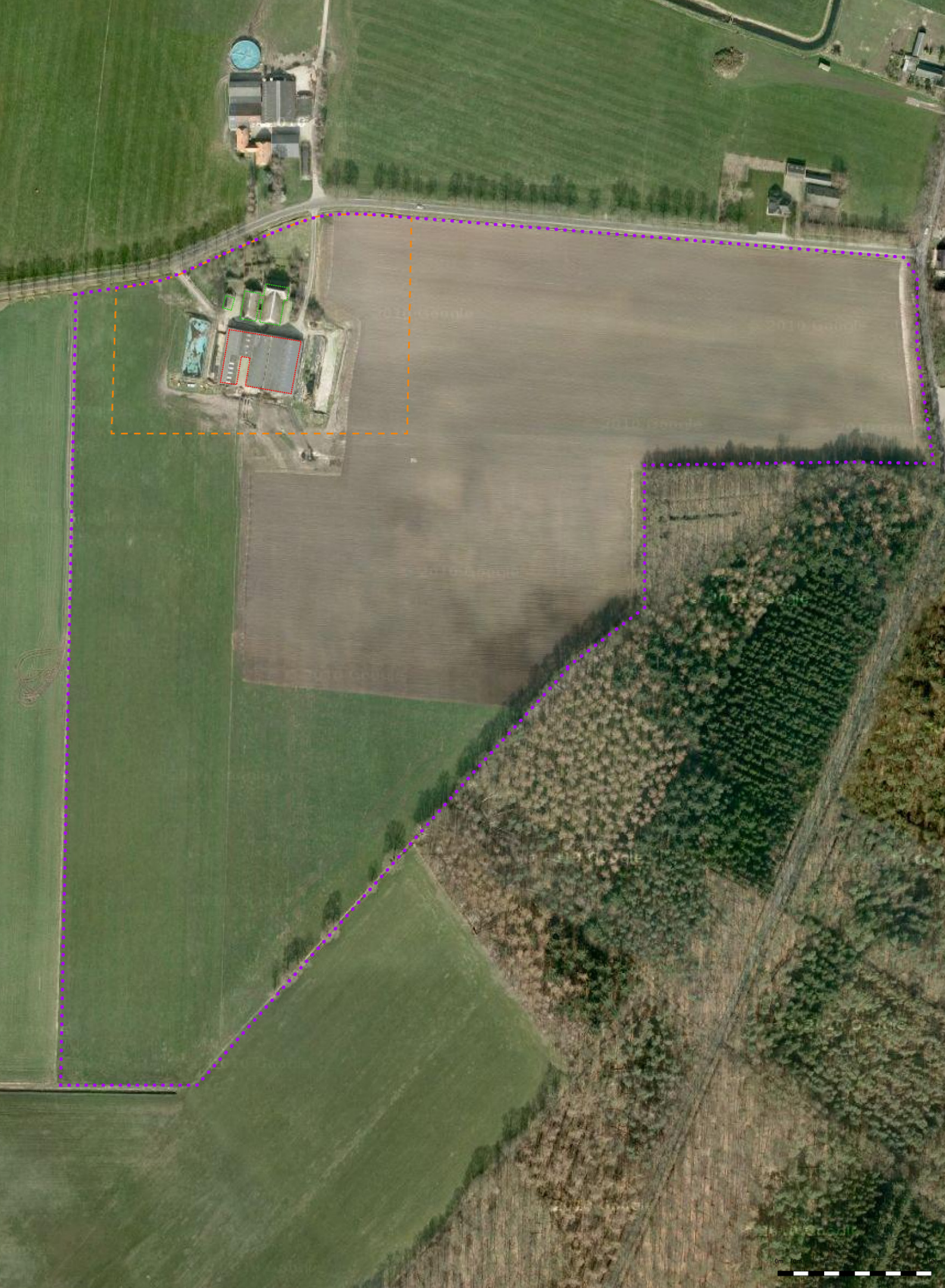
Afbeelding 1. Projectgebied met projectgrens (paars), bouwblok (oranje), te behouden boerderij (groen) en te slopen schuren, mestbassin en kuilvoerplaten (rood)
