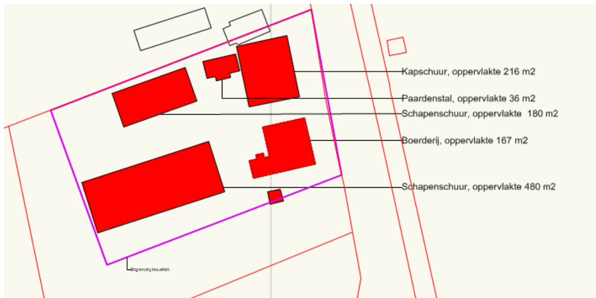
Overzicht te slopen gebouwen
