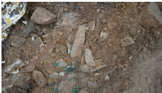
8-12 aantreffen asbesthoudend materiaal (puin)
