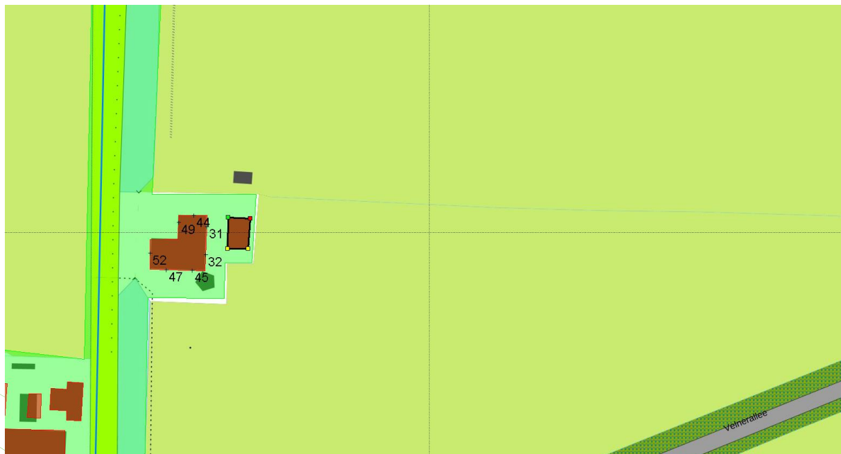
Figuur 5: Overzicht resultaten rekenmodel wegverkeer incl aftrek 5 dB conform art 110g Wgh
